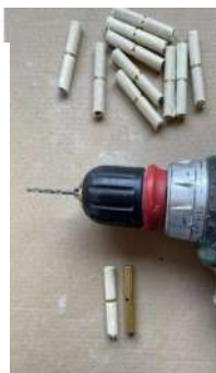
Obr. 140 Finální vrtání otvorů
