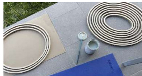
Obr. 134 Průběh povrchové úpravy
