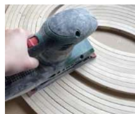
Obr. 136 Broušení pásovou bruskou
