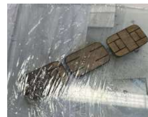
Obr. 122 Stříh mosazného kříže z laseru
