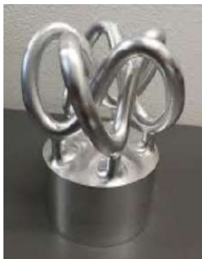
Obr. 71 Obrobek z 5tiosé frézky
