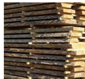
Obr. 52 Přirozené vysoušení masivu
