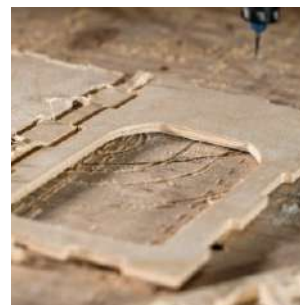
Obr. 70 Obrobek z 3tiosé frézky
