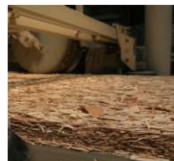
Obr. 58 OSB deska před lisováním
