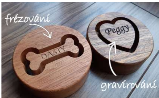
Obr. 103 Rozdíly mezi frézováním a gravírováním
