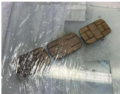
Obr. 157 Střih mosazného kříže z laseru
