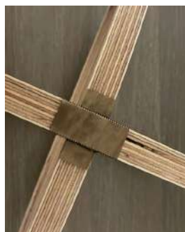
Obr. 158 Umístění mosazného kříže na překližkové obruče
