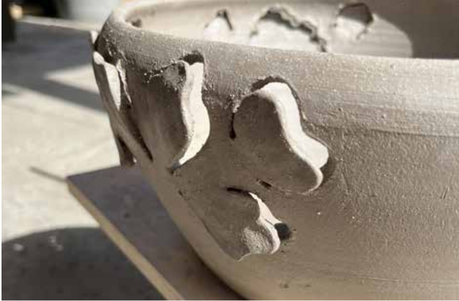
Obrázek 29: Ztenčení hrany výřezu (vlastní foto)
