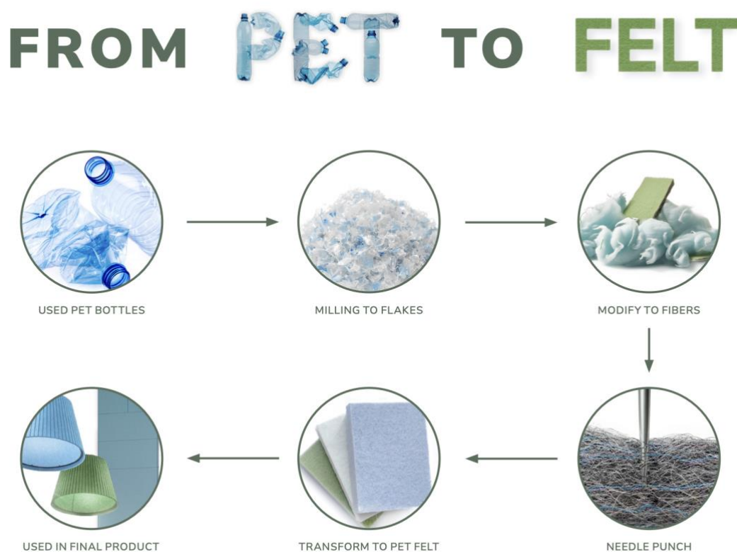
Obrázek 13 Proces výroby PET filcu 36
