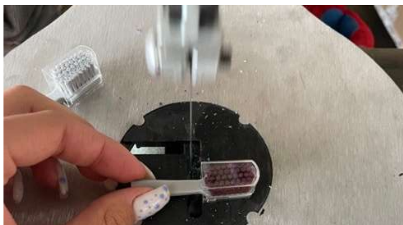
Obr. 38 Zrezanie prebytočného materiálu
