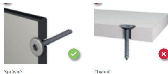
Obr. 15: Odporúčané použitie skrutiek 39
