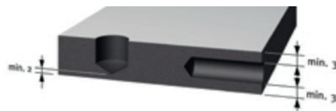
Obr. 14: Odporúčané miery pri vrtaní 37
