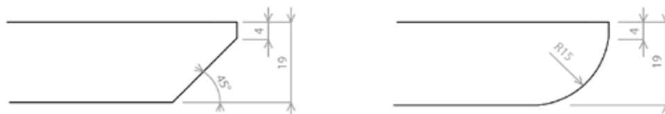
Obr. 52: Technická dokumentace – realizovaných hran (vlastní zdroj)
