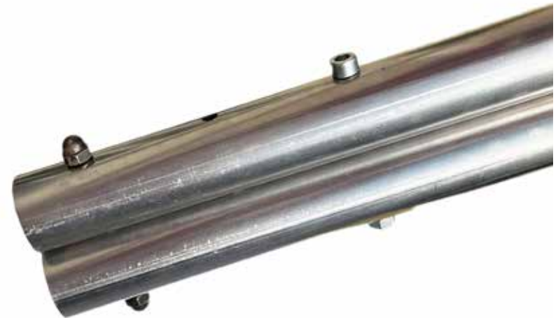
Obr. 32: Zkušební spoj ve vzdálenosti 100 mm (vlastní zdroj)
