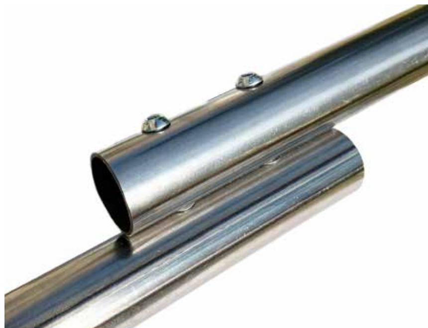
Obr. 33: Zkušební spoj pomocí nýtovací matice (vlastní zdroj)
