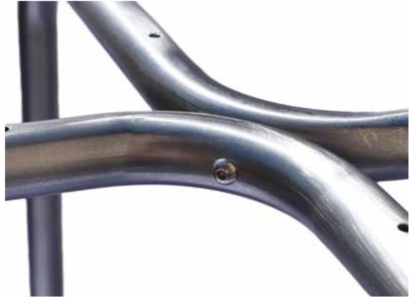
Obr. 50: Ukázka spoje stolových noh středem (vlastní zdroj)
