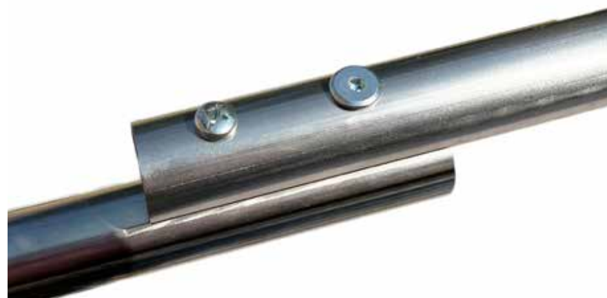
Obr. 30: Fotografie ze zkoušky šroubovaného spoje (vlastní zdroj)
