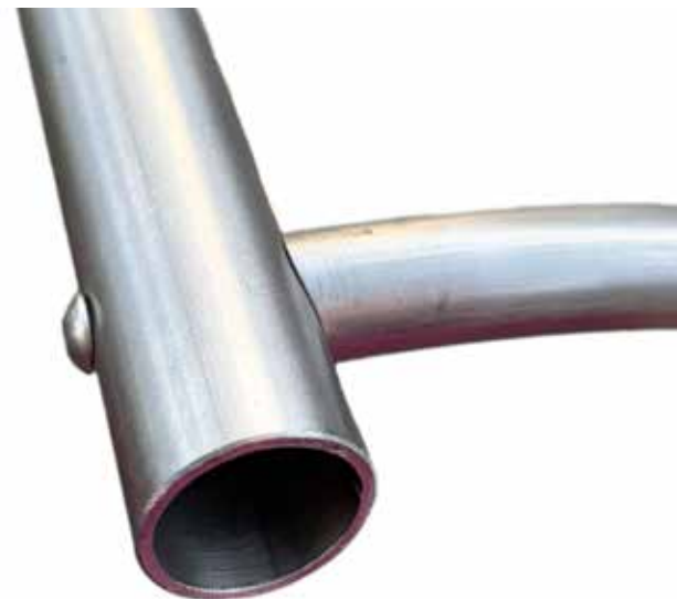
Obr. 49: Zkouška spojení trubek o průměru 25 a 16 mm (vlastní zdroj)
