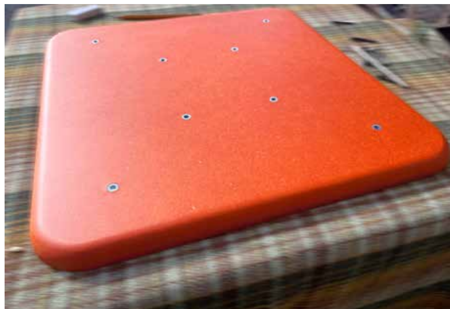
Obr. 57: Stolová deska se závrtnými maticemi (vlastní zdroj)
