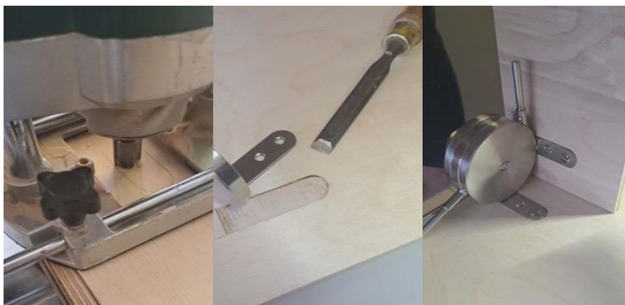
Obrázok 45: Frézovanie drážky pre osadenie pásoviny
