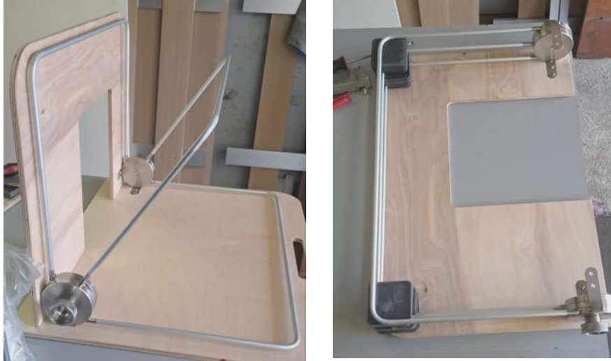
Obrázok 33: Mechanizmus rozkladania hliníkových rebier
