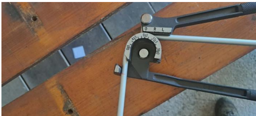
Obrázok 39: Ohýbanie hliníkových trubiek pomocou ohýbačky
