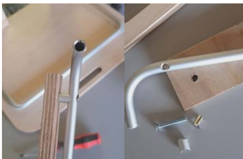
Obrázok 46: Detail uchytenia rebier pomocou dištančných trubičiek
